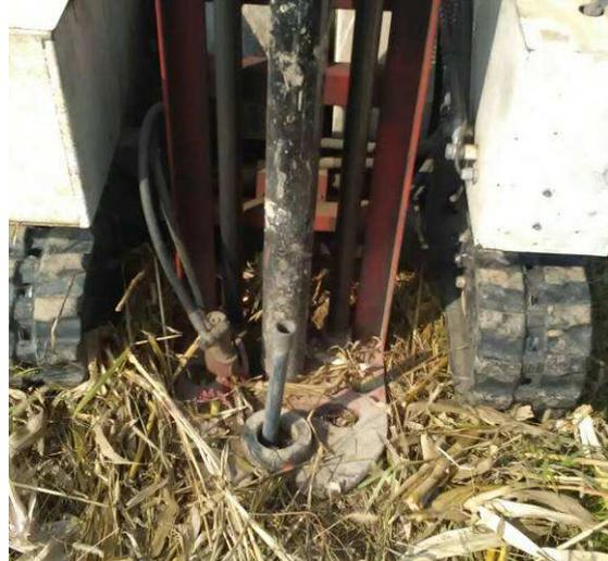
L’esecuzione di prove di permeabilità nei fori delle prove penetrometriche dinamiche SCPT non è realmente conforme alle specifiche in tal senso ma si ritiene l’approssimazione, anche in relazione alle finalità della determinazione, assolutamente accettabile.
